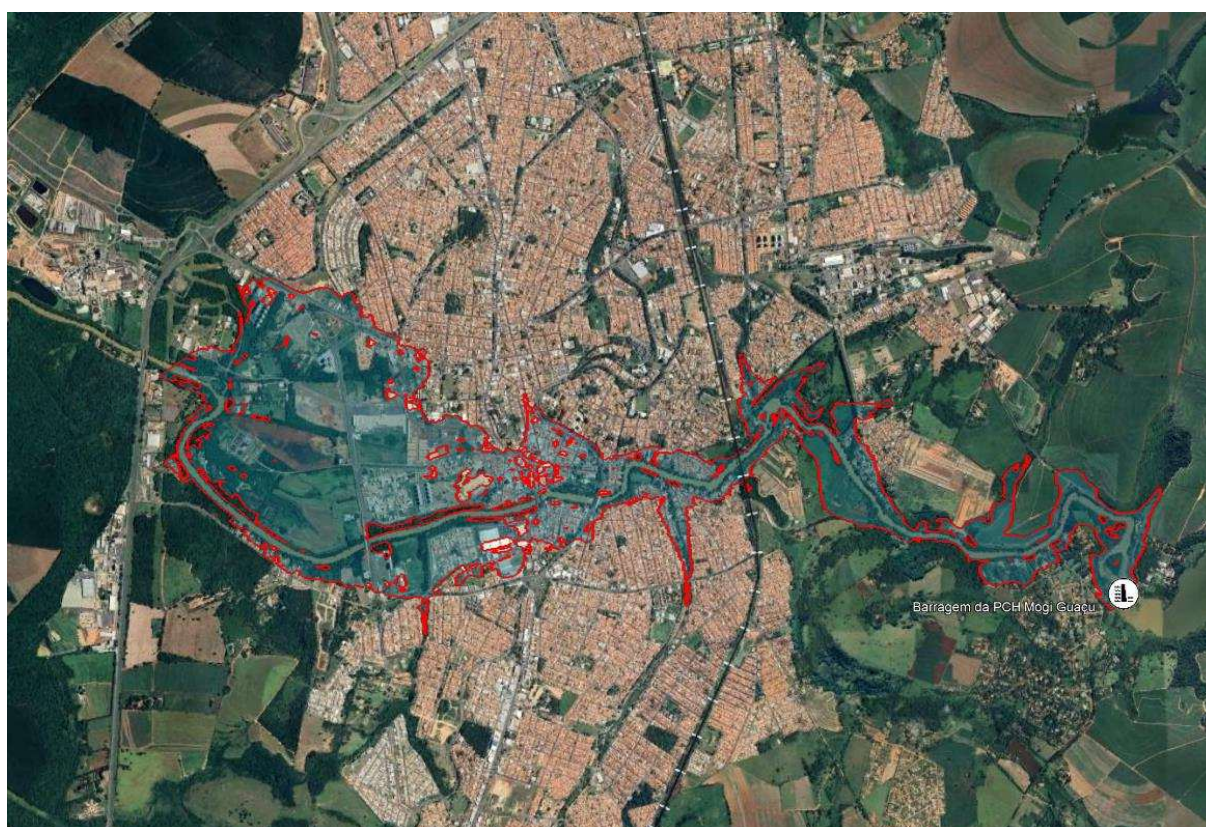
Figura 3 – Zona de Autossalvamento da PCH Mogi Guaçu
