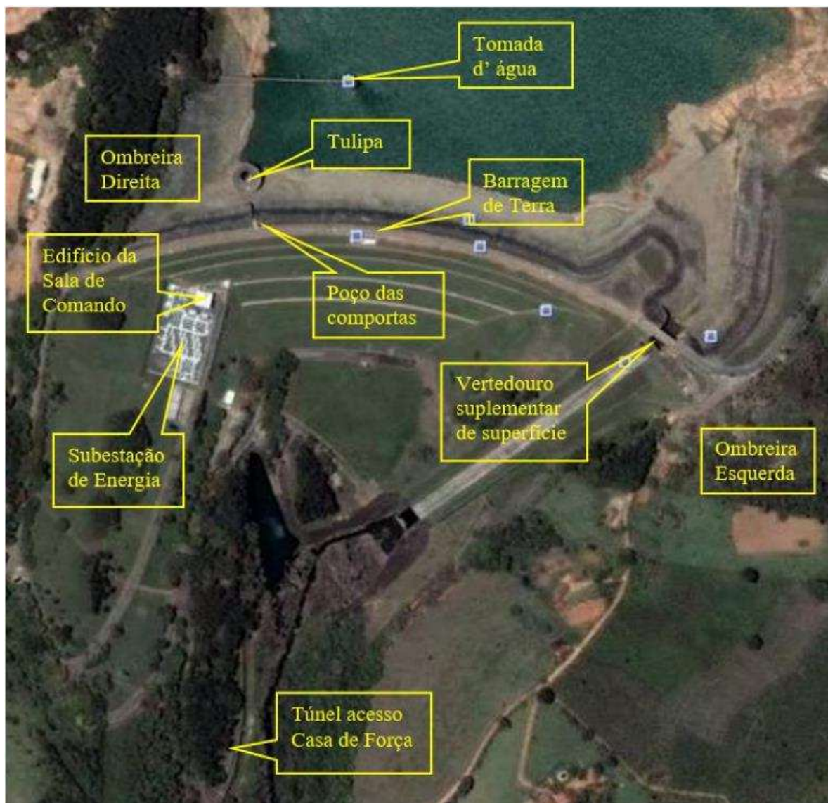
Figura 5 – Arranjo geral da UHE Caconde
