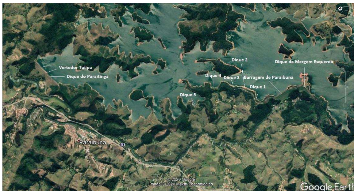
Figura 6 – Arranjo geral da barragem de UHE Paraibuna
